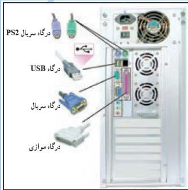
درگاه ها، محل هایی برای اتصال وسایل جانبی مانند صفحه کلید، ماوس، چاپگر و غیره با سیستم هستند.
